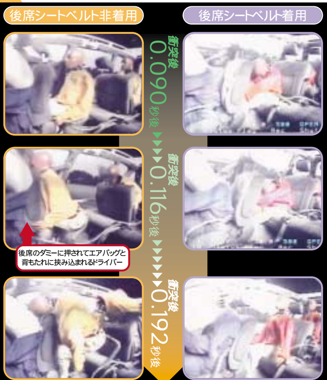
「後席シートベルト非着用」では、ダミーは着座姿勢のまま飛び出し、前のシートに体を強打。前席のドライバーは、エアバッグと背もたれに挟み込まれた。「後席シートベルト着用」のダミーは飛び出すことはなかった。
