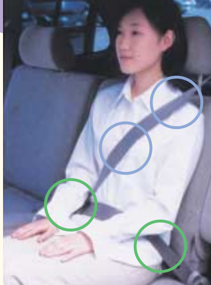
シートベルトは骨格部にかけます。○がシートベルトをかける鎖骨、胸骨、左右の腰骨の位置です。
